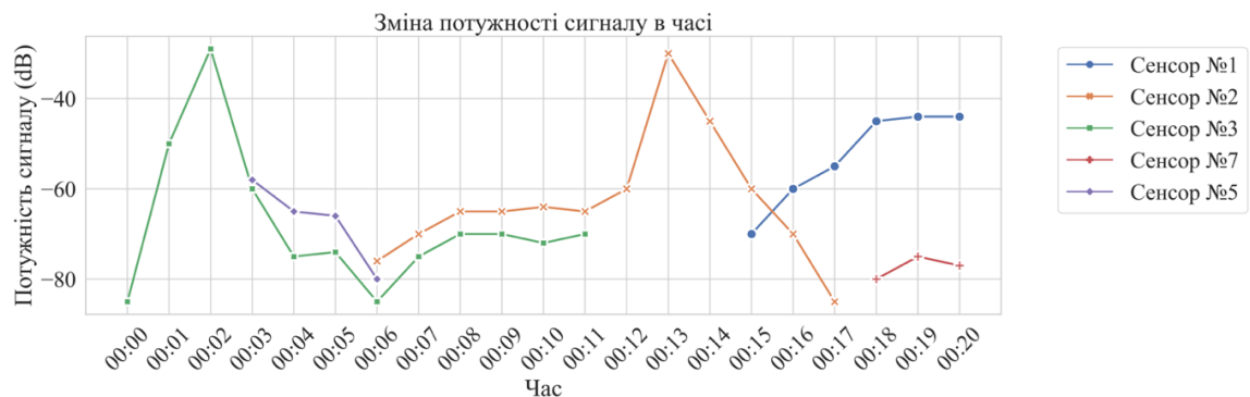
Рис. 3.17. Виявлення підміни MAC адреси у мережі Wi-Fi з системою виявлення вторгнень моделі WNaAS
