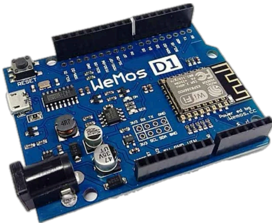
Рис. 2.7. Плата розробника Arduino WeMos D1 з Wi-Fi модулем ESP8266
