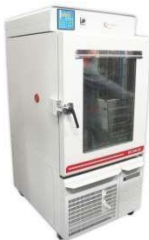
Рис. 3.1. Кліматична камера Kambic KK-50CH
