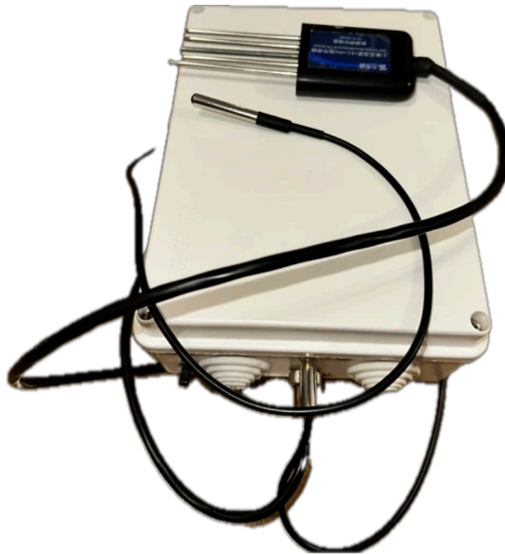
Рис. 2.11. Підсистема передавання даних про температуру, вологість, кислотність, провідність, та вміст фосфору, азоту, калію у ґрунті.
