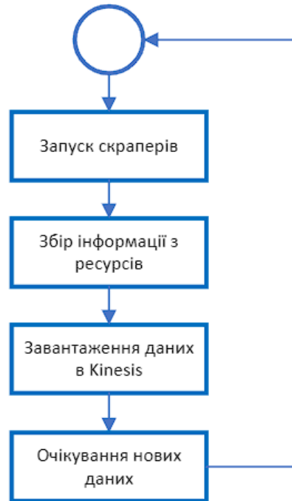
Рис. 4.9. Схема роботи скраперів
