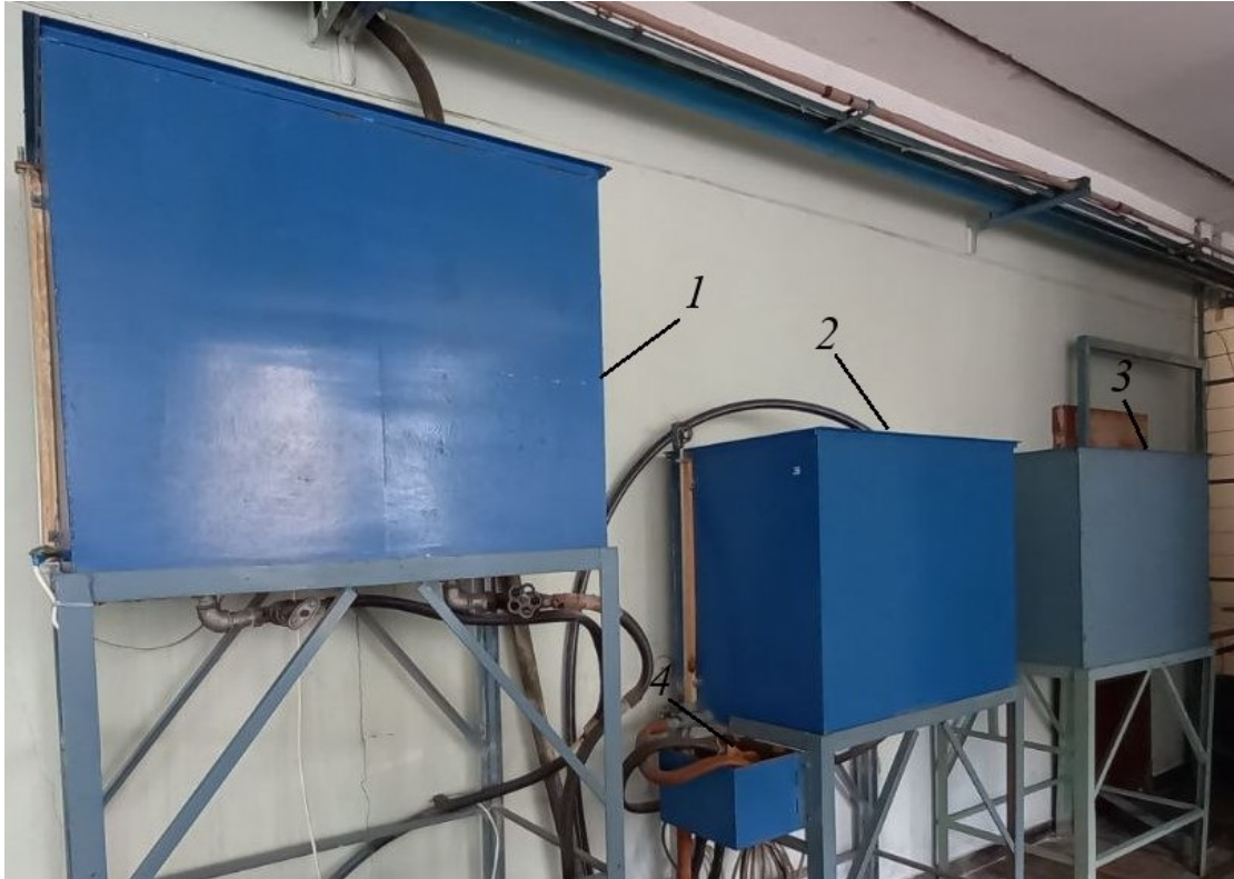
Рис. 3.4. Ємності для води: 1-3 – ємності; 4 – напірний бачок з водозливною стінкою
