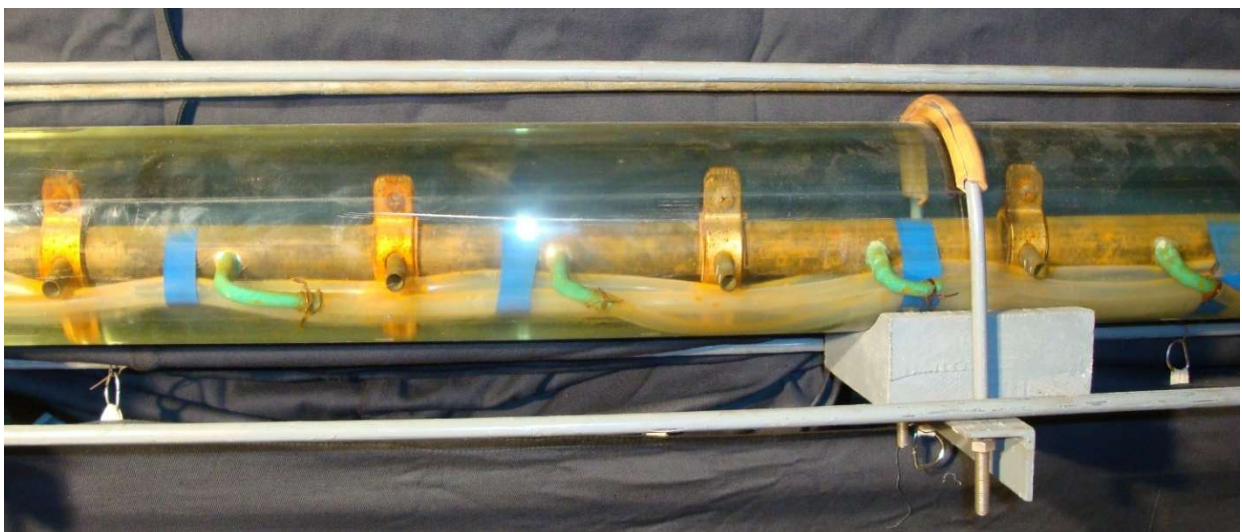
Рис. 3.6. Ділянка прозорого футляра із встановленим у ньому ТЗ
