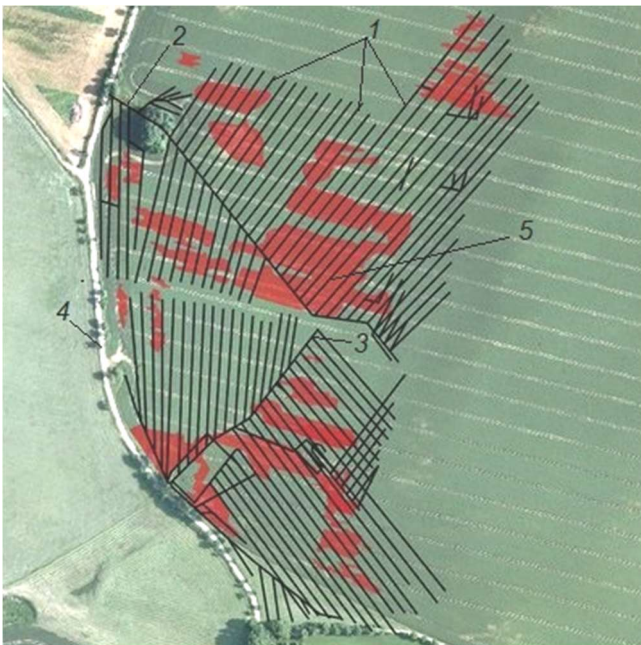
Рис. 1.5. Схема осушувальної системи з закритим дренажем: 1 – дрени; 2, 3 – закриті колектори; 4 – відкритий колектор (ріка); 5 – ділянки з високим рівнем ґрунтових вод (світлина взято з сайту
