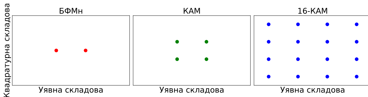
Рис. 1.1. Сигнальні сузір'я БФМн, КФМн та 16-КАМ
