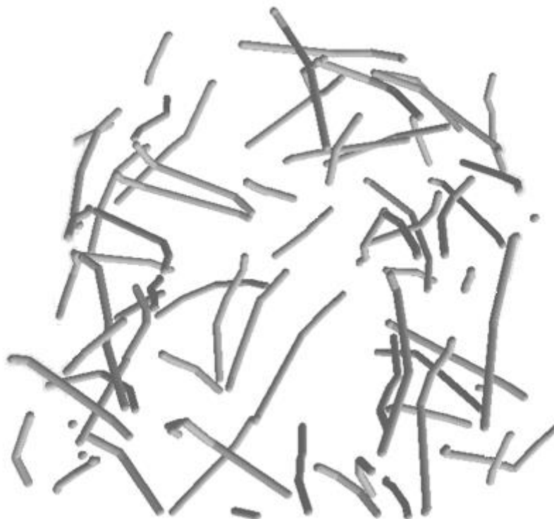
Рис. 3.12. Тривимірне представлення мережі вигнутих нанотрубок. Вигнуті трубки складаються з 5 сегментів, для кожного сегмента максимальний кут кривизни становить 50^\circ
