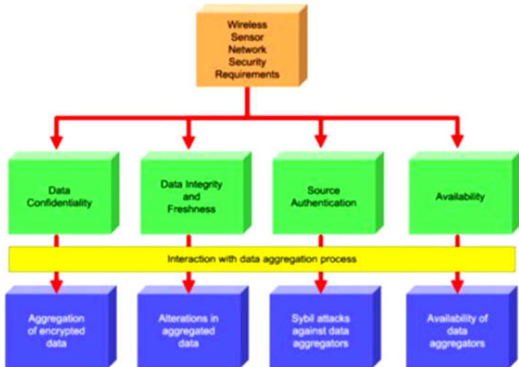
Рисунок 2.3. Взаємодія між безпекою бездротової сенсорної мережі та процесом агрегації даних
