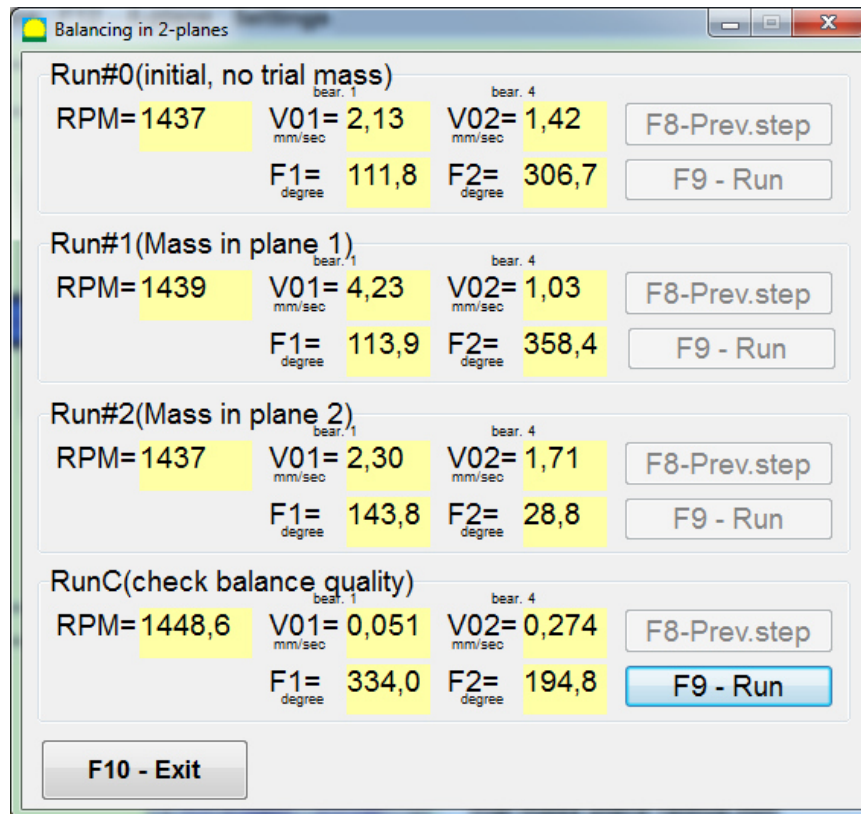
Рис. 6.23. Протокол динамічного балансування обертових частин у зборі
