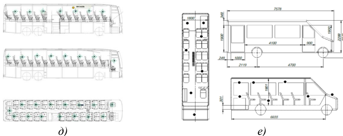
Рисунок 1.1 – Розміщення датчиків для вимірювань показників мікроклімату в салонах автобусів: а) приміському, міському та міському зчленованому [39]; б) міському малого класу [25]; в) туристичному великого класу [29]; г) туристичному середнього класу [37]; д) туристичному особливо великого класу [124]; е) мікроавтобусі [49]
