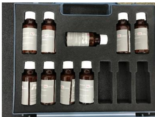
Рис. 2.2 Набір тестових чорнил компанії AFS для визначення поверхневої енергії полімерних плівок
