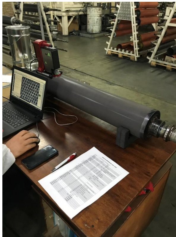
Рис. 2.6. Вимірювання параметрів анілоксових валів із застосуванням 3D-мікроскопа AniCAM
