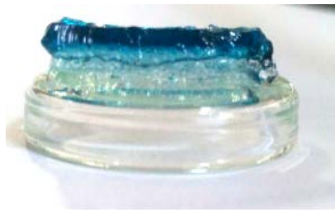
Рис. 6.5. а) схематичне зображення структури комбінованого поліакриламід-желатинового гідрогелю, б) фотографія фрагменту експериментального зразка такого гідрогелю: верхній шар желатиновий – забарвлений барвником амідочорним 10 Б; нижній шар поліакриламідний – прозорий.
