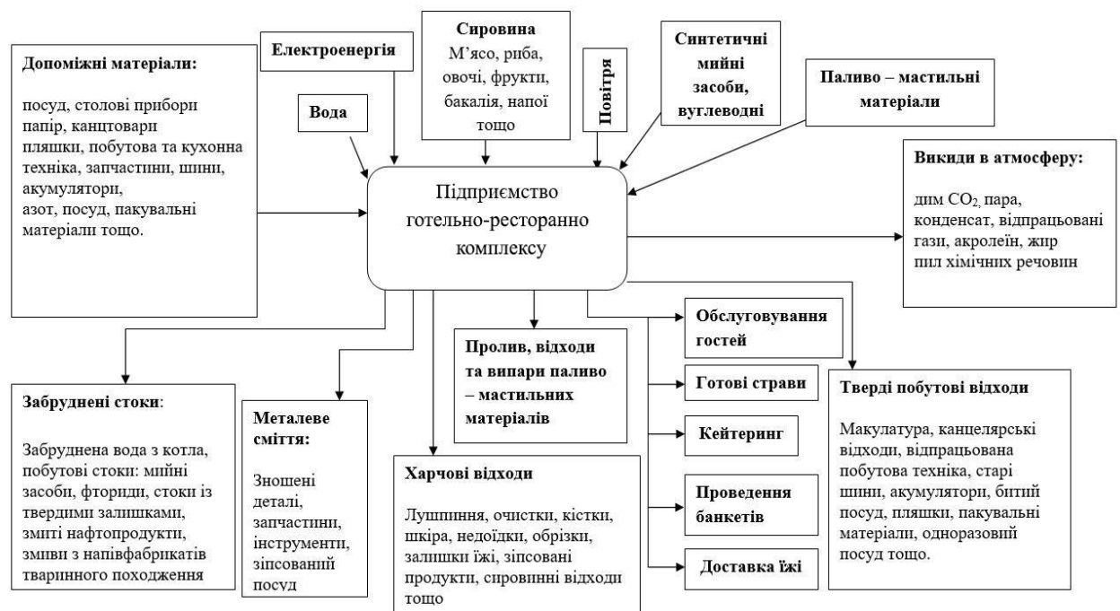
Рис. 3.5. Схема аналізу життєвого циклу готельно-ресторанного комплексу
