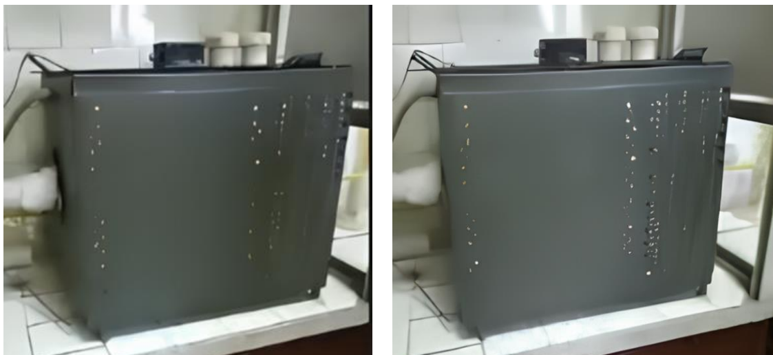
Рис. 2.4. – Експериментальна установка для піролізу відпрацьованої кавової гущі.
