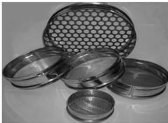
Рис. 2.6. Сита для визначення гранульованого складу біочарів
