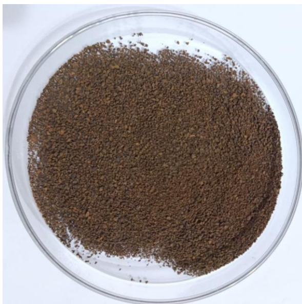
Рис. 2.2. Відпрацьована кавова гуща підготовлена до термічного та мікрохвильового піролізу.
