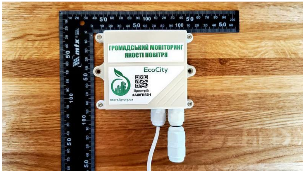
Рис.2.2. – Пристрій для моніторингу якості повітря на відкритому повітрі, оснащений системою термокомпенсації
