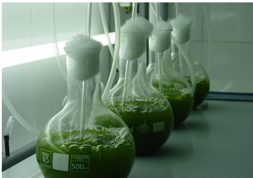
Рис.2.2 Процес барботування суспензії мікроводоростей вуглекислим газом.
