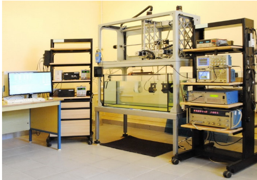
Рисунок 2.1 – Національний державний первинний еталон одиниці ультразвукового тиску у водному середовищі НДЕТУ АUV-02-2018
