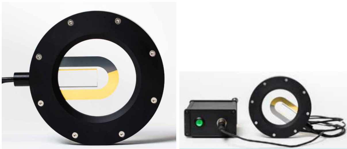
Рисунок 1 - Мембранний гідрофон фірми GAMPT типу MH12, який буде використаний в рамках пілотного звірення (зовнішній діаметр опорного кільця - 130 мм)
